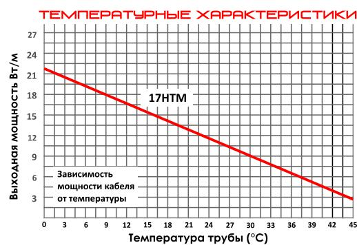
Выходная тепловая мощность на изолированной металлической трубе.
